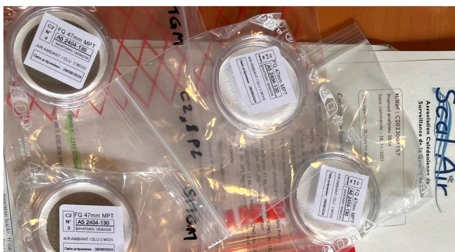
Figure 11 : Exemple de filtres blancs et échantillons après prélèvement et avant envoi en laboratoire pour la pesé des particules fines PM10 et l'analyse des métaux
